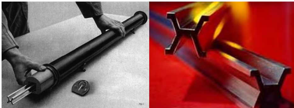
Slika 2.4. Prototip metra iz 1889. godine
